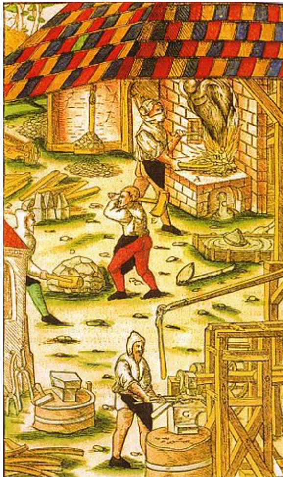
Eisenhammer. Im Hintergrund sieht man den Rennofen, davor wird eine Luppe grob von Schlacken-Resten befreit. Ganz im Vordergrund geschieht das Ausschmieden der Luppe unter dem Hammer. (aus: Agricola, Georgius 1556)
